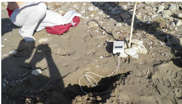
Εικόνα 4.12.: Στιγμαία μέτρηση θερμοκρασίας άμμου με ειδικό θερμόμετρο τύπου KD2 Pro.
